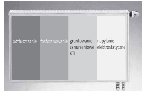
Przygotowanie powierzchni grzejnika
