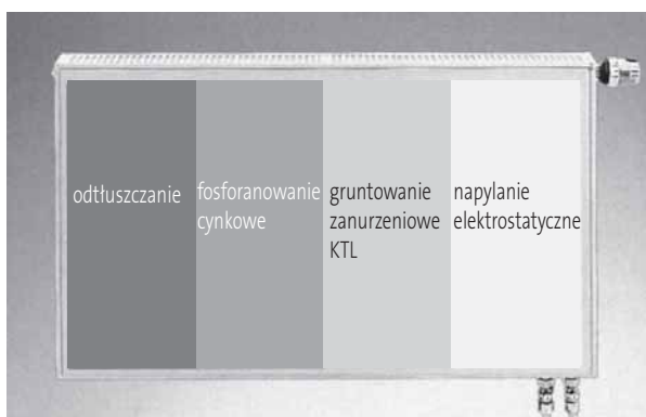
Przygotowanie powierzchni grzejnika
